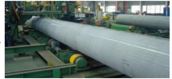
STEP 3 : Pipe 밴딩
