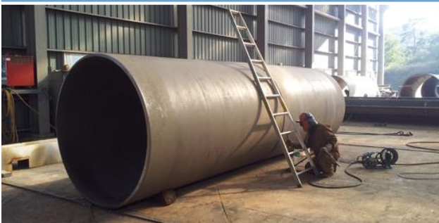
STEP 4 : Main Pipe 조립, 용접
